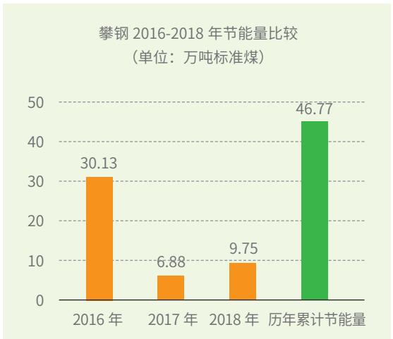
2018年，攀钢组织开展二次能源回收利用专项对标，通过开展对标及措施的实施，转炉煤气回收量达7.99亿立方米，比2014年增加18%；余热蒸气回收量1797万吉焦，比2014年增加2.5%。
