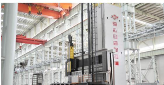
超重型数控单柱移动立式铣车床
