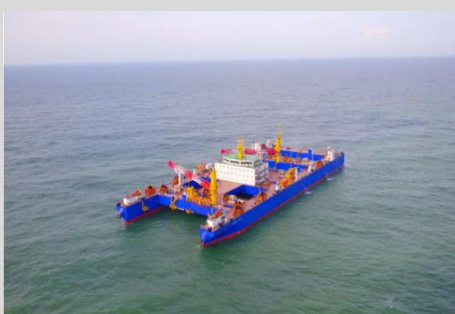
世界首艘沉管浮运安装一体船“一航津安 1”
