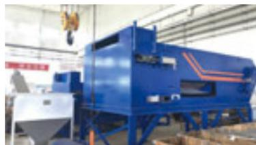
国机集团下属国机重工研制河道清淤污泥脱水成套设备
