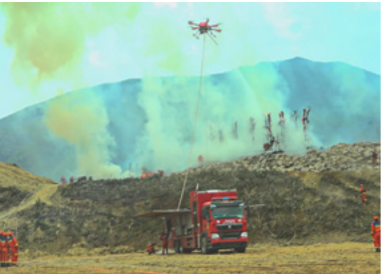
新兴际华集团自主研发空地协同大载荷系留无人机消防救援装备，整套装备高度集成，采用智能协同控制，可实现 240 公斤级大载荷系留无人机空中灭火，能够破解百米以上高层建筑暂无有效消防救援的世界级难题。
