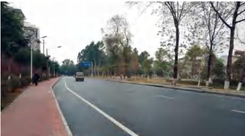
韶关钢铁厂南大道于1987年建成使用，一直是韶关钢铁社区和生产区交通联络的主干道，但由于使用年限长，存在路面破损、排水不畅、照明设施老化等问题。2019年，韶关钢铁投入2300余万元对厂南大道进行升级改造，共计完成改造道路总长4890米、修复损坏路面12450平方米、加铺沥青混凝土路面61164平方米，改造完的厂南大道规划有序、整洁明亮。
