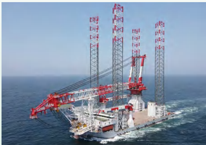
2000 吨自升式海上风电安装平台——“大桥海风”号
