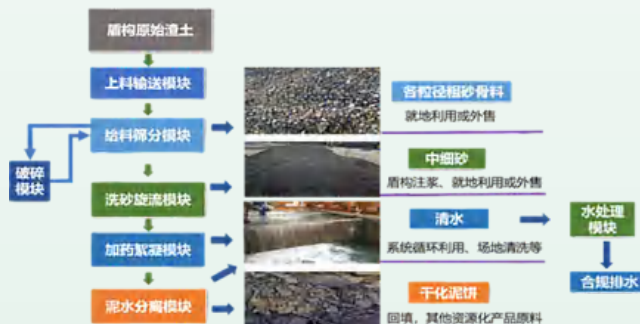
盾构渣土高效资源化处理系统流程图
