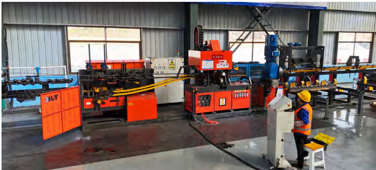
钢筋自动焊接
