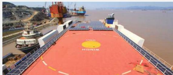
2023 年 7 月 3 日，舟山中远海运重工完成中远海特旗下 5000 车位汽车滚装船“中远盛世”轮太阳能光伏系统改装工程，每天可减少 0.8 吨柴油的消耗，年平均可以减少碳排放约 200 吨。
