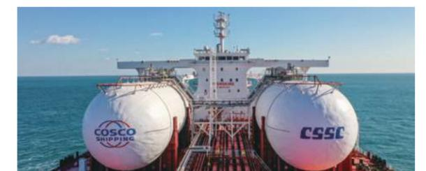
中远海运能源接入的全球首艘 LNG 双燃料超大型原油轮（VLCC）“远瑞洋”轮，以 LNG 作为船舶动力来源时，该船续航力可达 1.2 万海里，燃油与燃气总计续航力为 2.4 万海里，按标准工况计算，碳排放将降低约 20%，硫排放可减少 95% 以上。
