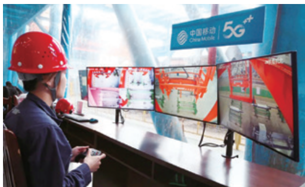
○ 工人在广西公司打造的智慧绿色工厂中通过手柄远程操控装载机
