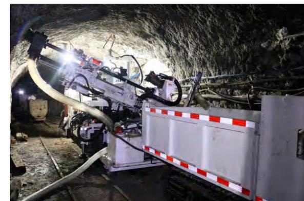
重庆研究院承担的“煤矿井下自动钻孔作业线关键技术及装备”项目实现了井下钻孔“一人巡检”的少人化施工新模式，填补了国内煤矿钻孔作业线技术与装备空白
