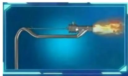
电站煤粉锅炉灵活深度调峰无助燃点火及稳燃技术
