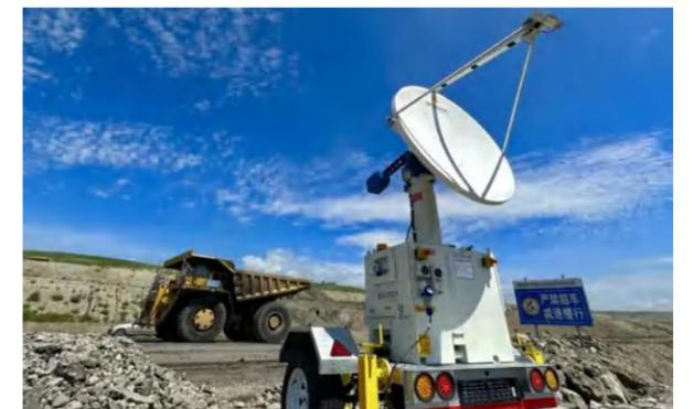
沈阳研究院建立的“现场+远程”边坡雷达监测预警系统成功应用于扎哈淖尔煤业公司，实现了远程实时监测监控高陡边坡片帮、滑坡等地质灾害的目标，全面提升了矿区安全生产水平
