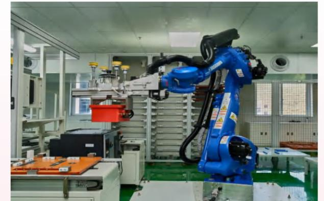
常州股份研制的矿用电源类产品高密度智能化柔性老化、在线测试系统，可同时满足 36 台电源老化，并实现产品在线测试，全程无人参与。通过 AGV 运送、堆垛机构上料、系统控制等自动完成，并将该研究成果应用于智能工厂电源类产品高密度封闭式智能老化和在线测试线，最终实现 210 台电源类产品自动老化、测试，消除人工参与搬运、跌落砸伤、无人值守引发火灾等安全隐患，在确保产品质量的前提下大幅提升了电源老化效率。
