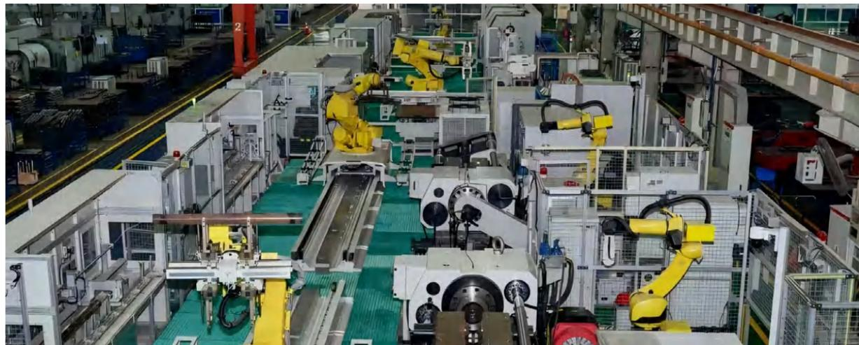
重庆研究院建设的国内首条连续流钻具自动化生产线
