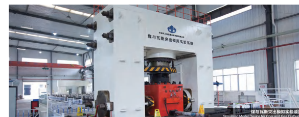
世界第一的瓦斯煤尘爆炸试验系统
