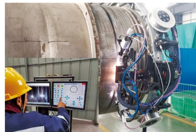
成功自主研发窄间隙氩弧焊接机器人，解决主管道焊接的“卡脖子”问题
