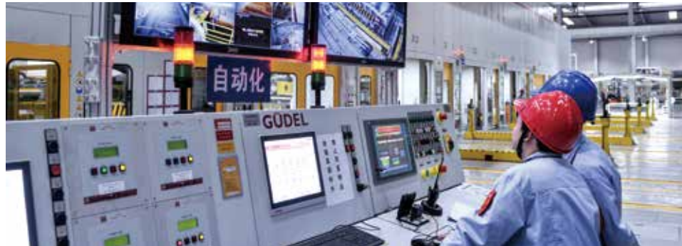
冲压车间采用国内自主研发、制造的压机，拥有2条5序“多连杆机械压机+双臂横杆传输方式”的封闭式高速冲压生产线，智能化程度达到国内一流水平。
