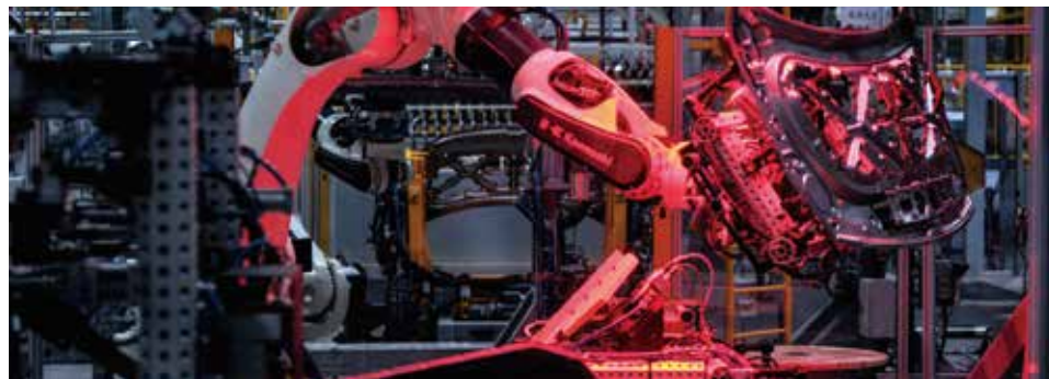
焊接车间采用同平台、多车型柔性共线生产，拥有机器人535台，自动化率达92%，达到国内一流水平。
