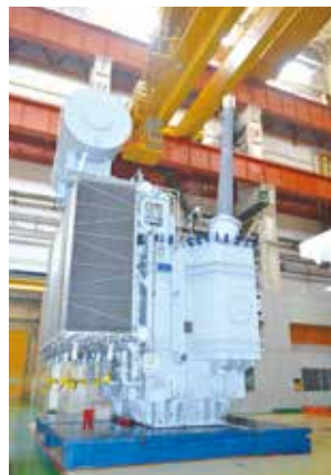
出口美国单相 280MVA/500kV 油浸芯式发电机变压器
